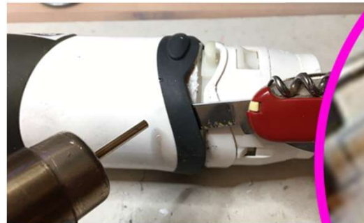
Stabmixer Verschweisste Gehäuseteile
