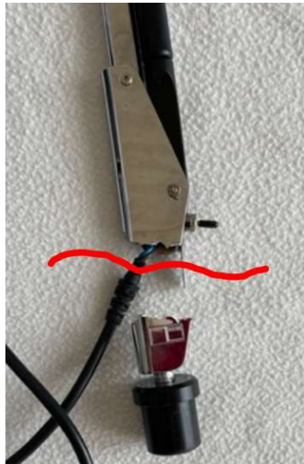
Tischleuchte Befestigung bricht
